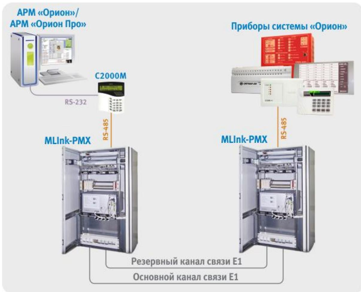
Выход RS-232 пульта C2000M подключен к COM-порту ПК, выход RS -485 пульта C2000M подключен к входу RS -485 MLink-PMX, выход RS -485 с MLink-PMX подключен к стенду с приборами ИСО «Орион».
