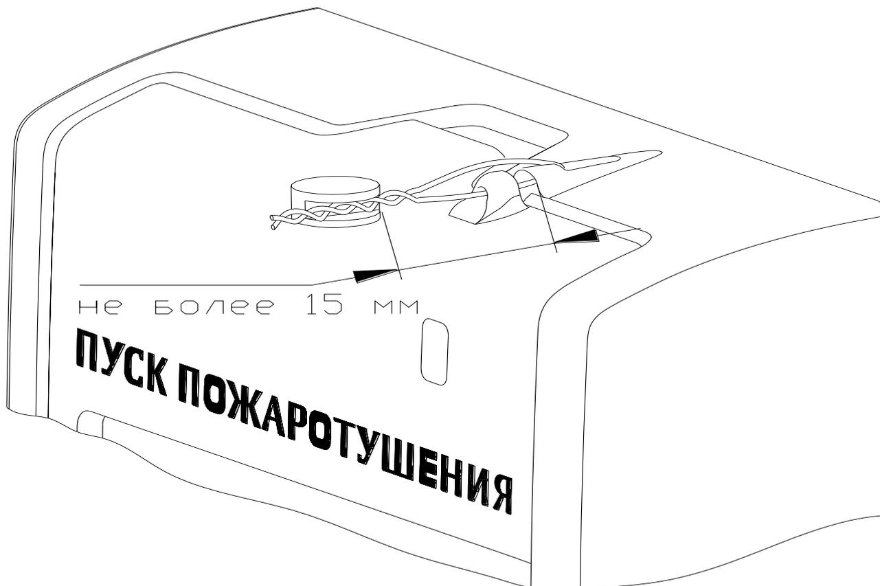
**Рисунок 2.2.3.2** Пломбировка УДП
