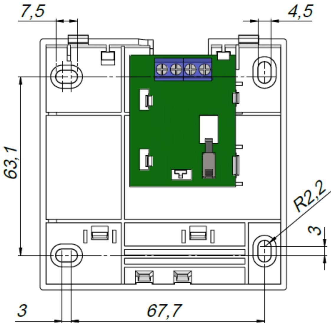
Рисунок 2.2.2.2 Установочные размеры УДП
