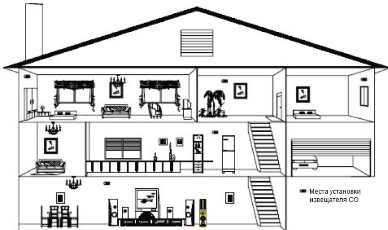
Рисунок 2.2.3.1 – Выбор местоположения извещателя
