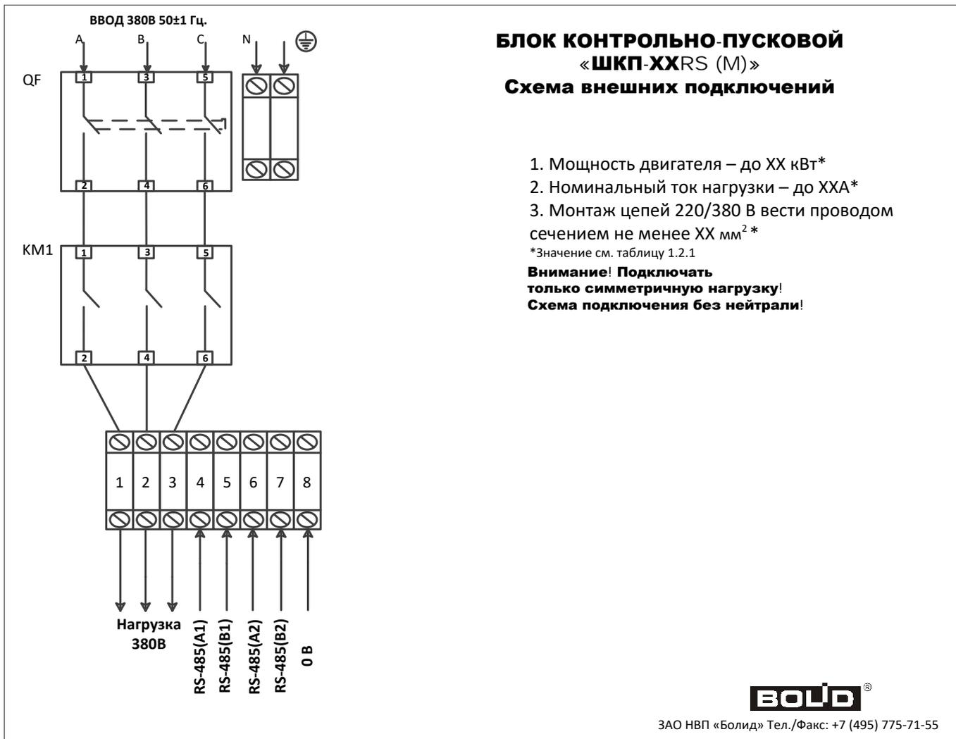
**Рисунок 26.** Схема подключения блоков ШКП-XXRS (M) при 380В.
