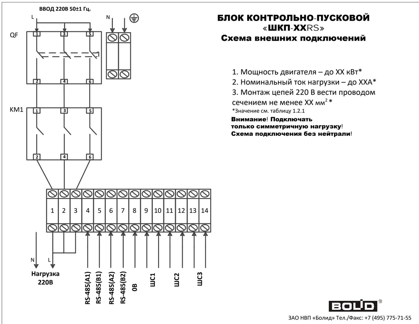
**Рисунок 2в.** Схема подключения блоков ШКП-4-10-18-30RS при 220В.
