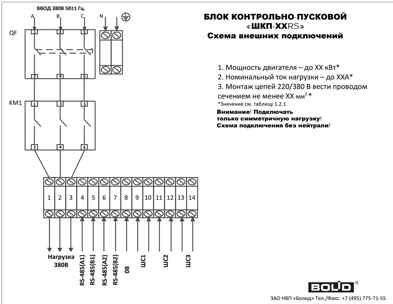
**Рисунок 2а.** Схема подключения блоков ШКП-XXRS при 380В.
