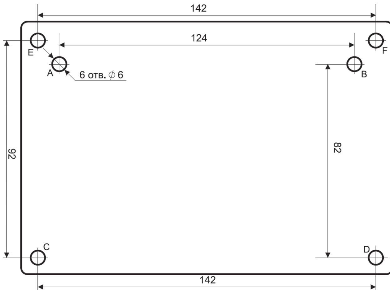
**Рисунок 2.2.4** – Схема сверловки для монтажа блока на стену.
