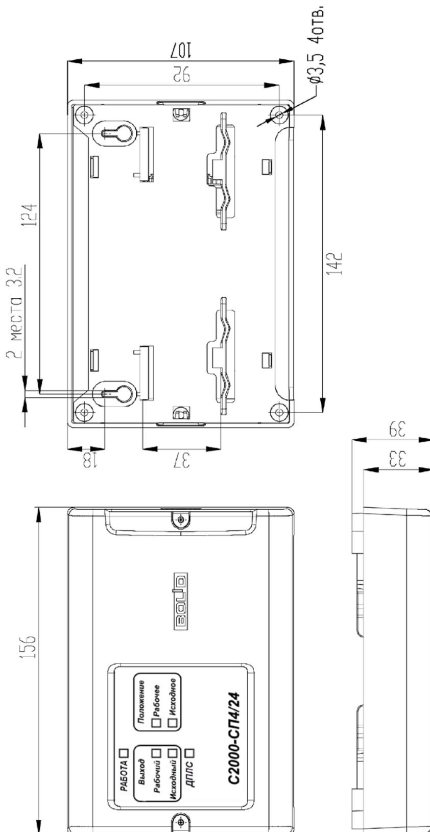
Рисунок 2.2.1 – Внешний вид и габаритно-установочные размеры блока.
