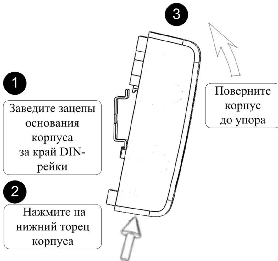
**Рисунок 2.2.3** – Схема установки блока на DIN рейку.
