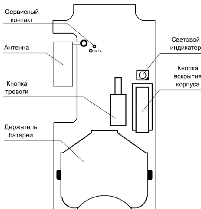
Рисунок 2.2.2.4-1 Расположение элементов на плате
