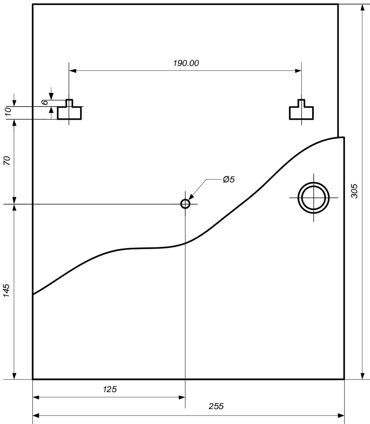
Рисунок 4. Габаритные и установочные размеры блока
