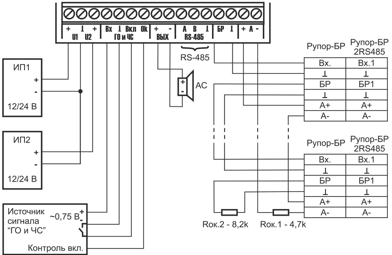
Рис. 6. Схема подключения блока «Рупор исп.02»
