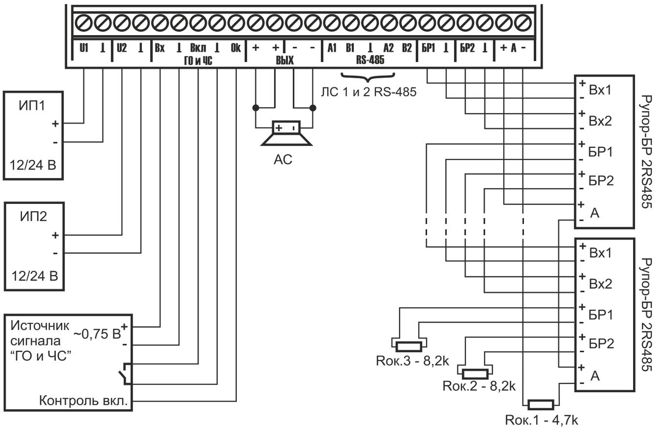
Рис. 7. Схема подключения блока «Рупор исп.02 2RS485»
