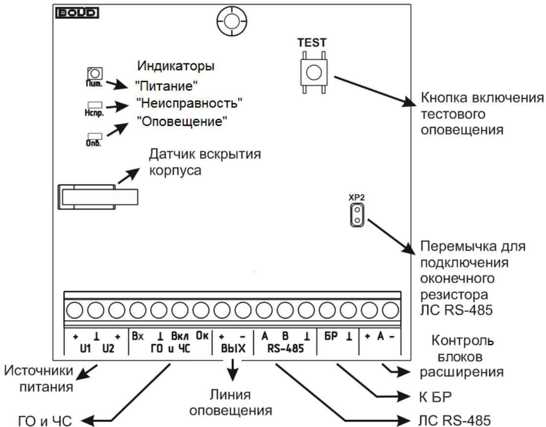
**Рис. 1.** Органы управления и индикации блока «Рупор исп.02»
