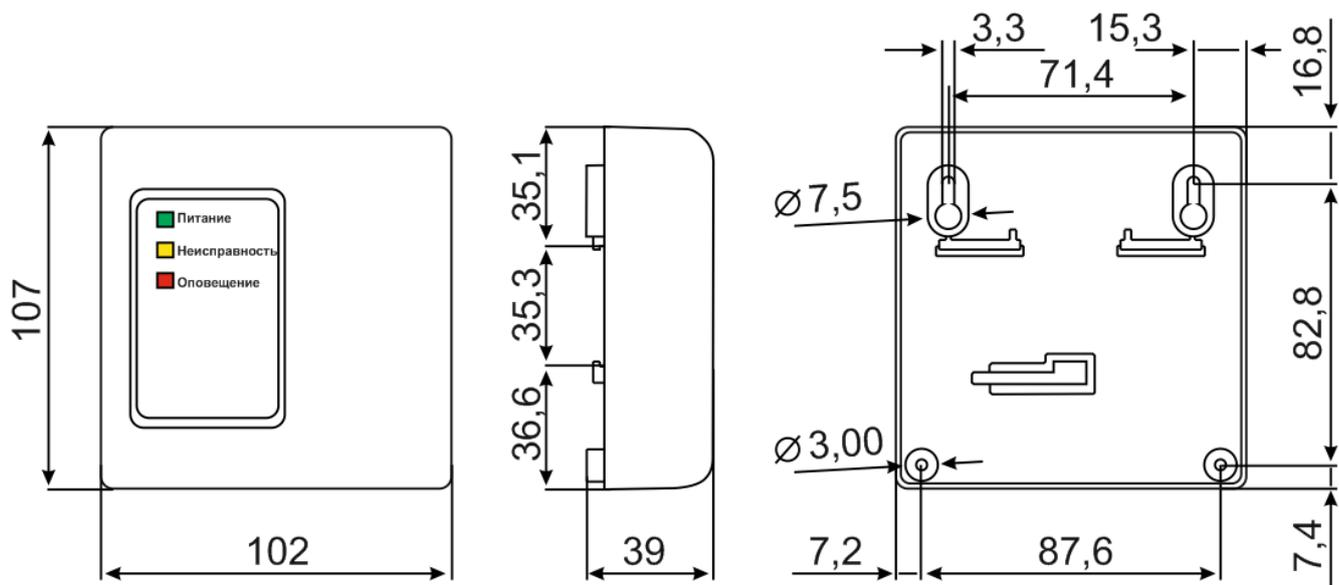
**Рис. 4.** Внешний вид, габаритные и установочные размеры «Рупор исп.02»
