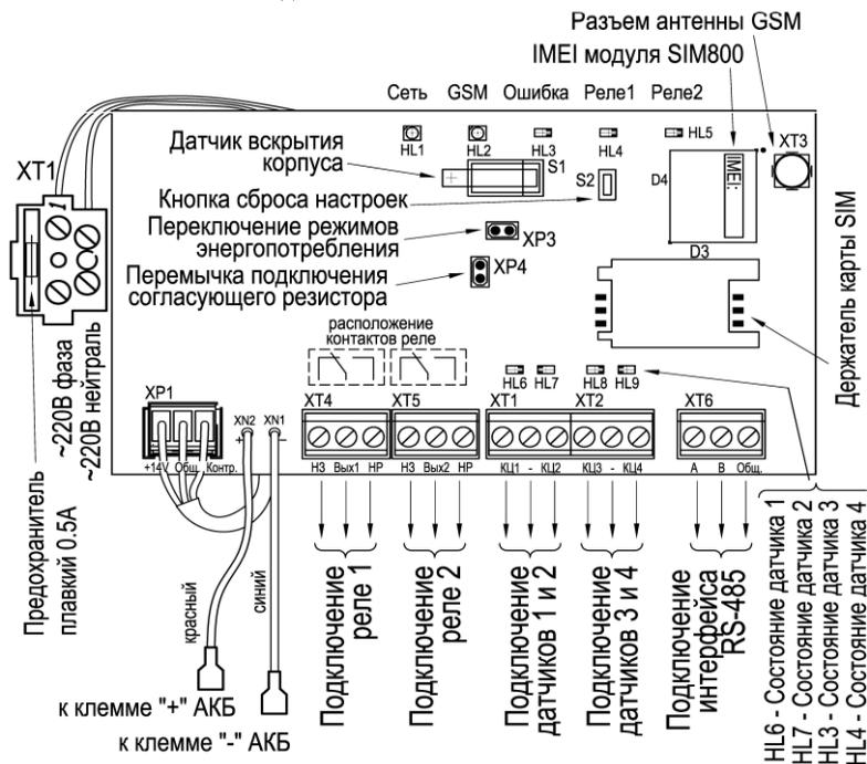
**Рисунок 1.** Схема внешних подключений
