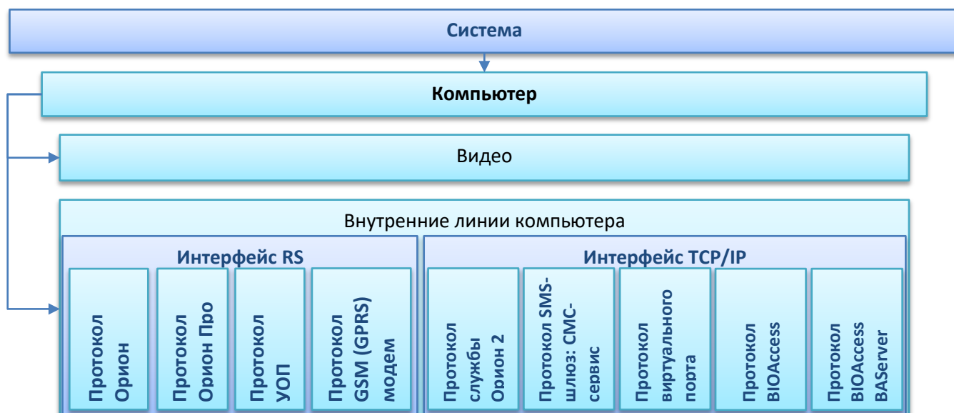
Рисунок 6-64 Схематическое отображение цепочки объектов «Система – Внутренняя линия компьютера» и возможностей выбора протокола линии в зависимости от интерфейса
