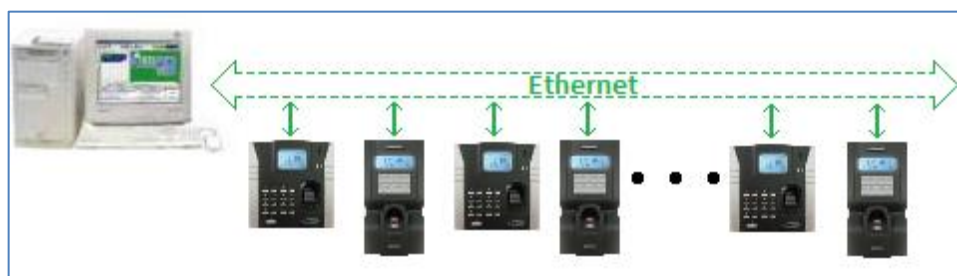
Рисунок 1-14 Схема подключения биометрических считывателей
