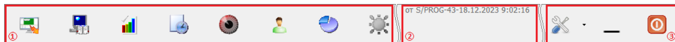
Рисунок 5-2 Интерфейс программного модуля "Оболочка системы Орион Про". Здесь 1 – кнопки запуска программных модулей, 2 – информационное поле, 3 – служебные кнопки
