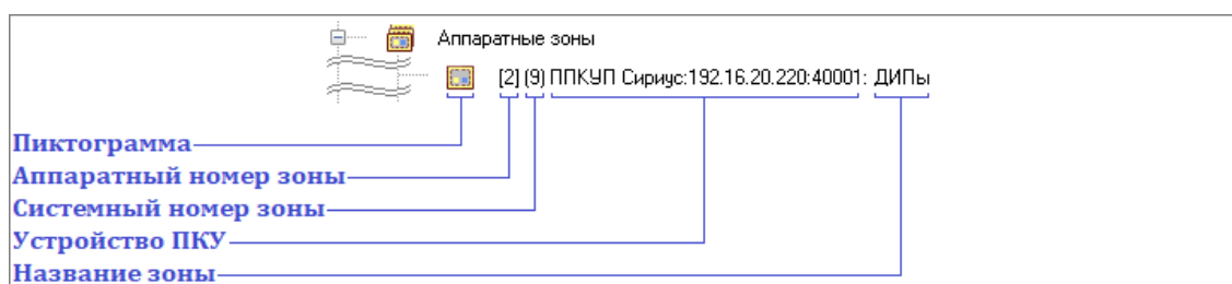
Рисунок 6-291 Отображение объекта "Аппаратная зона" в дереве зон как принадлежащего узлу "Аппаратные зоны"
