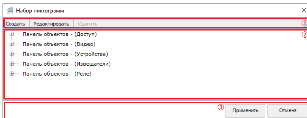
Рисунок 6-498 Интерфейс окна редактора "Набор пиктограмм". Здесь: 1 – кнопки редактирования элементов, 2 – дерево видов пиктограмм, 3 – кнопки действий
