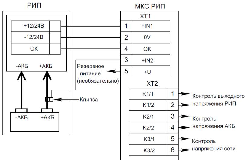
Рисунок 2. Подключение в режиме контроля состояния РИП-12/24.
