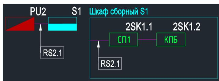
Линии связи, прокладываемые от оборудования расположенного внутри области шкафа до края границы шкафа, будут доступны для вывода их из УГО шкафа на плане этажа.
