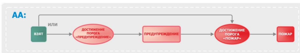
Алгоритм В: Может быть рекомендован для автоматических пожарных извещателей в системах, где нет системы оповещения 5 типа и систем пожаротушения.
