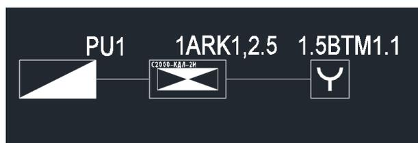
Подключаемые по интерфейсу RS-485 ведомые устройства С2000-КДЛ 2И исп.01, С2000-КПБ, Поток-3Н и т.д., имеют адрес, совпадающий с адресом их ведущего прибора. В данном случае «1», далее следует буквенная маркировка, например, у С2000-КДЛ – «ARK», затем указывается количество линий подключения по одному или двум интерфейсам (в примере — по двум интерфейсам «1, 2»), далее собственный адрес контроллера — «5».
