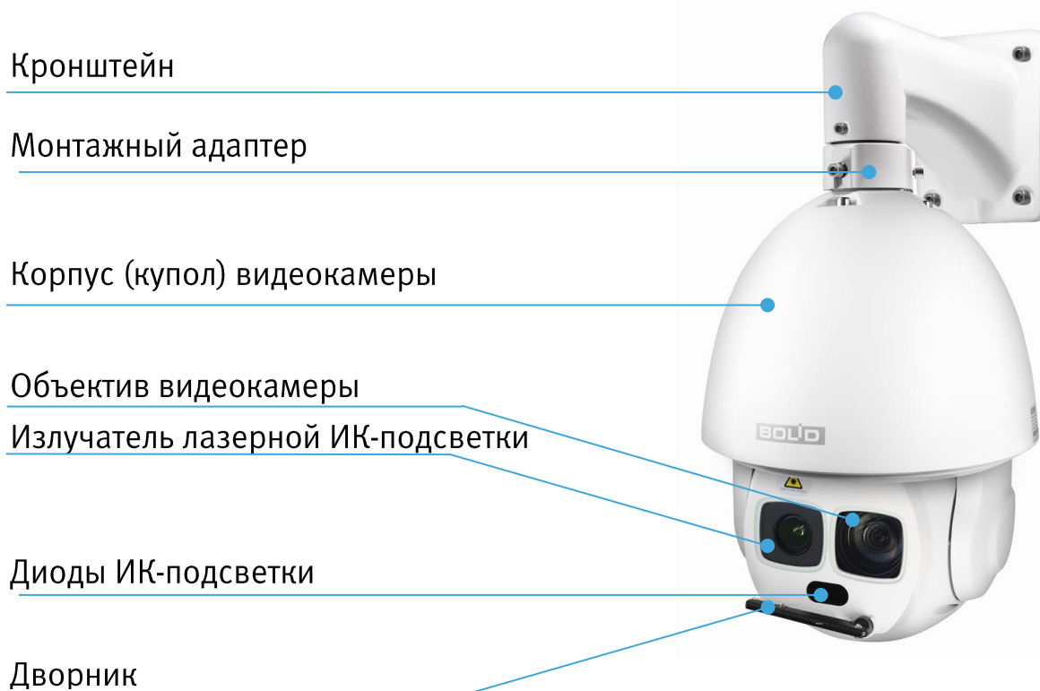
Рисунок 4.1 – Внешний вид и основные элементы видеокамеры
