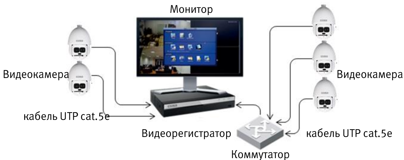
Рисунок 6.4 – Схемы подключения видеокамеры к видеорегистратору
