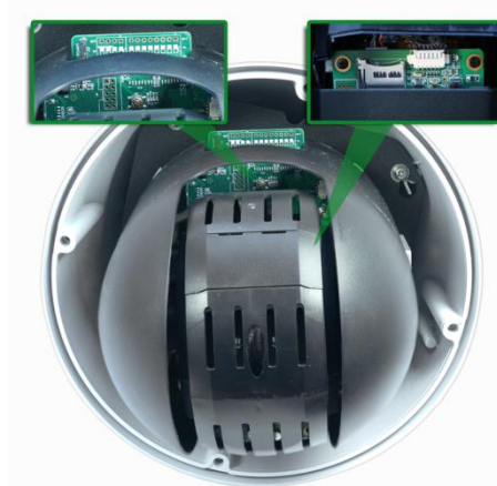
Рисунок 2.2 – Расположение кнопки аппаратного сброса и слота для карты памяти «Micro SD»
