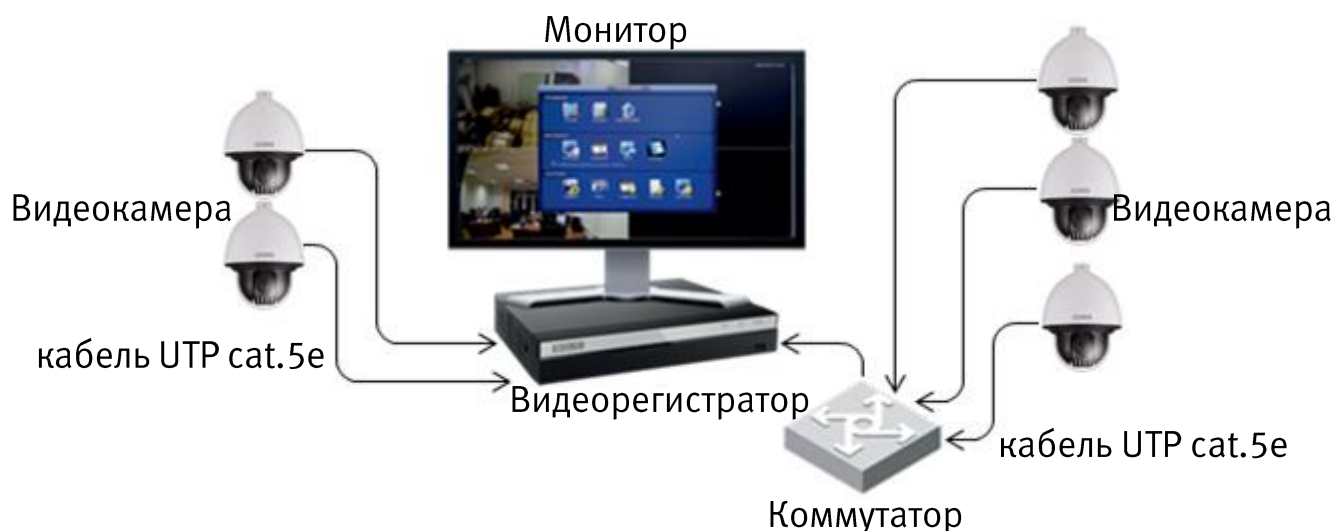
Рисунок 2.5 – Схема подключения видеокамеры к видеорегистратору
