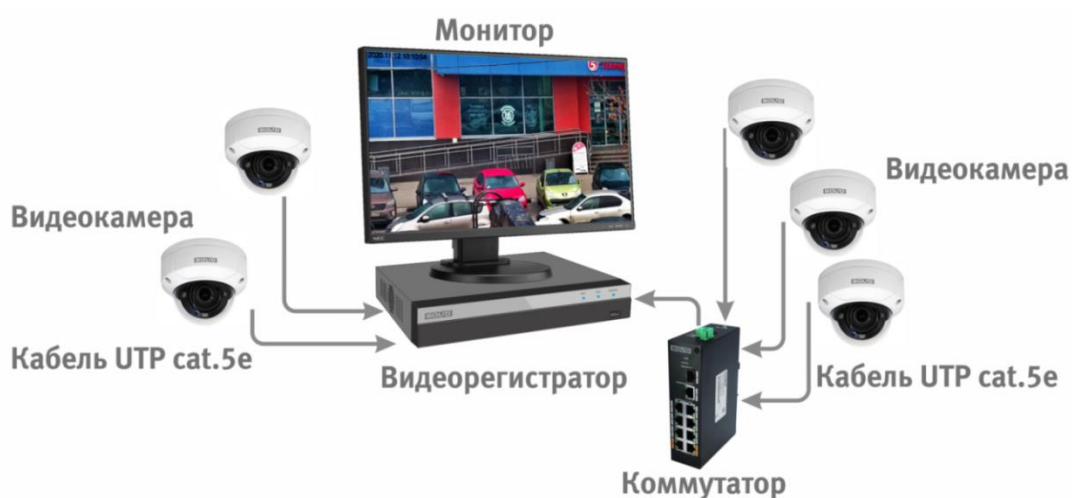
Рисунок 6.4 – Схема подключения видеокамеры к видеорегистратору
