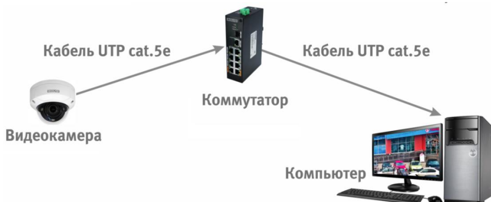
Рисунок 6.3 – Схема подключения видеокамеры к компьютеру через коммутатор
