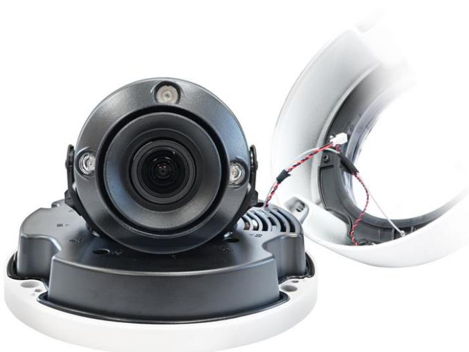
Рисунок 5.2 – Отсоединение корпуса
