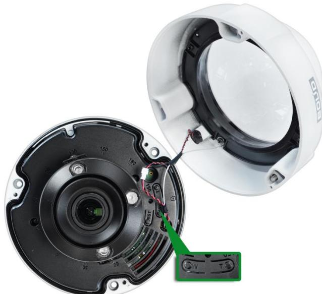
Рисунок 5.15 – Настройка фокусного расстояния вручную
