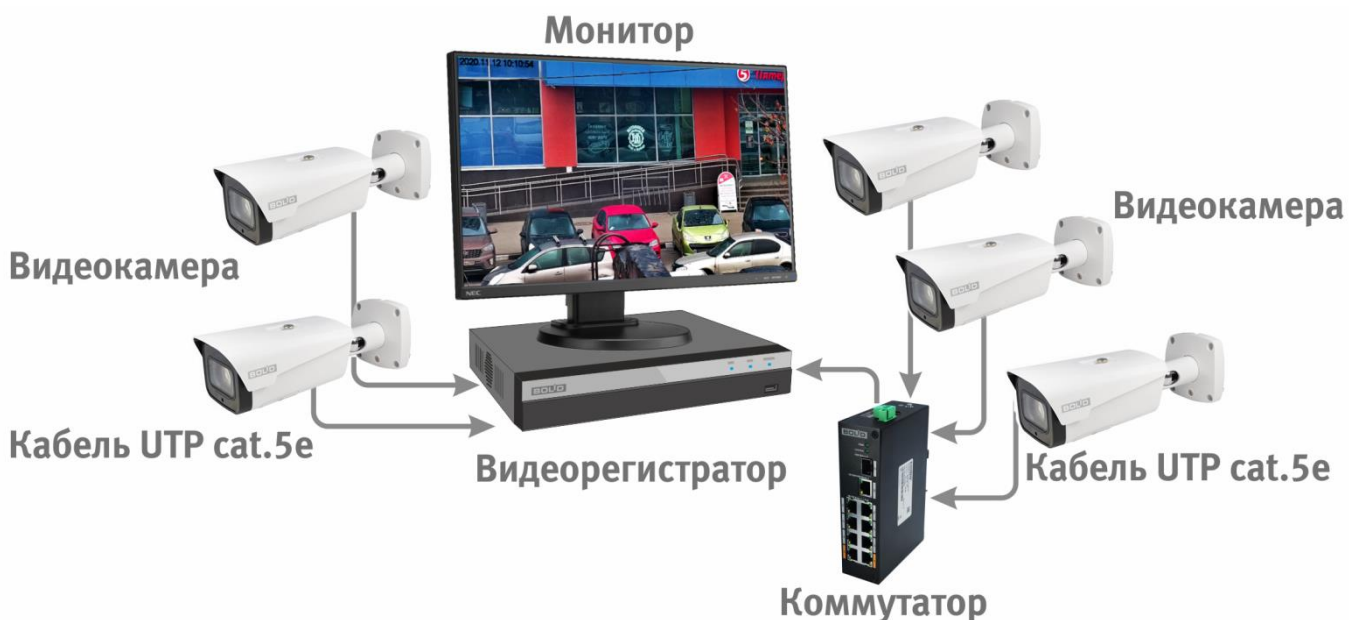
Рисунок 6.5 – Схема подключения видеокамеры к видеорегистратору
