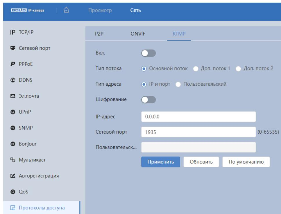
Рисунок 8.21 – Вкладка «RTMP»
