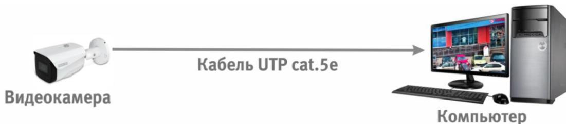
Рисунок 6.2 – Схема подключения видеокамеры к компьютеру
