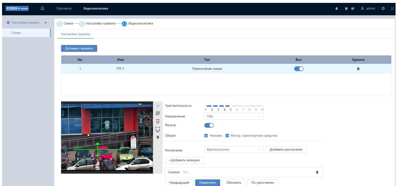
Рисунок 7.20 – Создание правила видеоаналитики «Пересечение линии»
