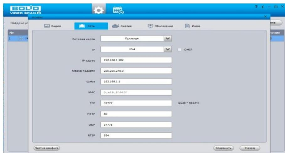
Рисунок 13.2 – Изменение IP-адреса видеокамеры с помощью утилиты «BOLID VideoScan»
