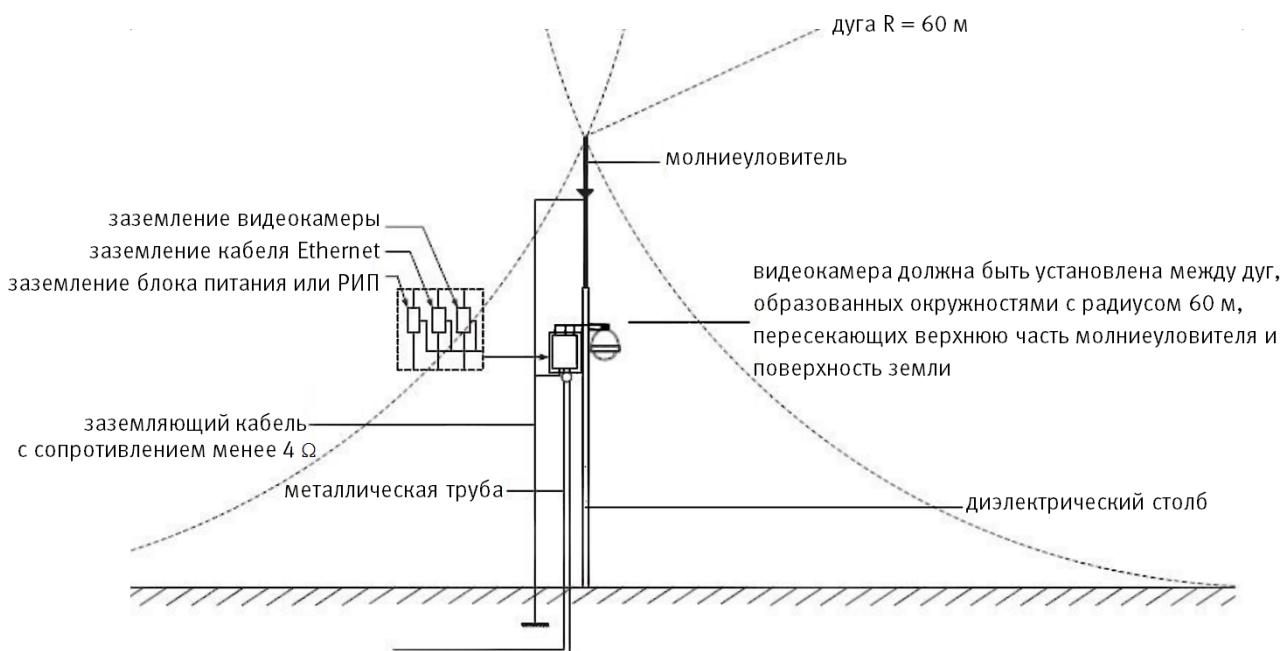
Рисунок 6.13 – Установка молниеотвода
