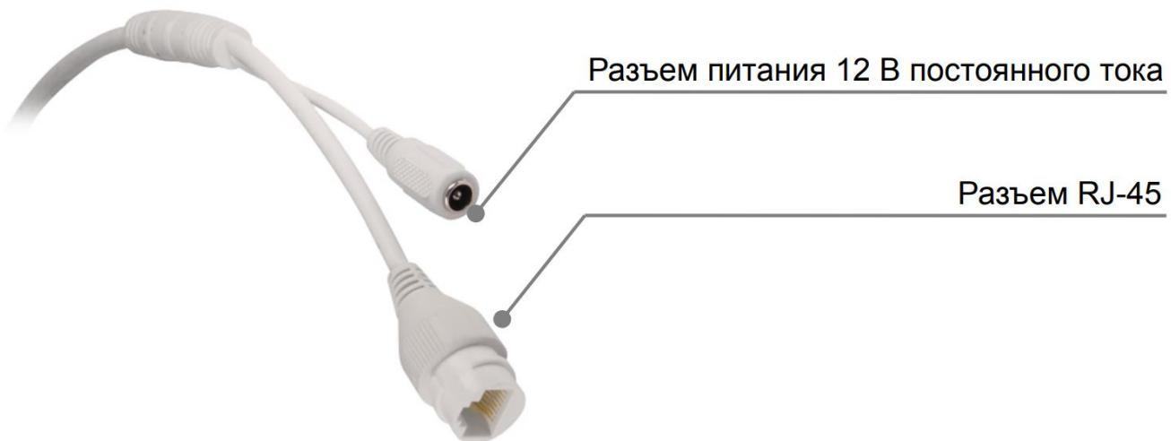
Рисунок 6.1 – Кабель видеокамеры
