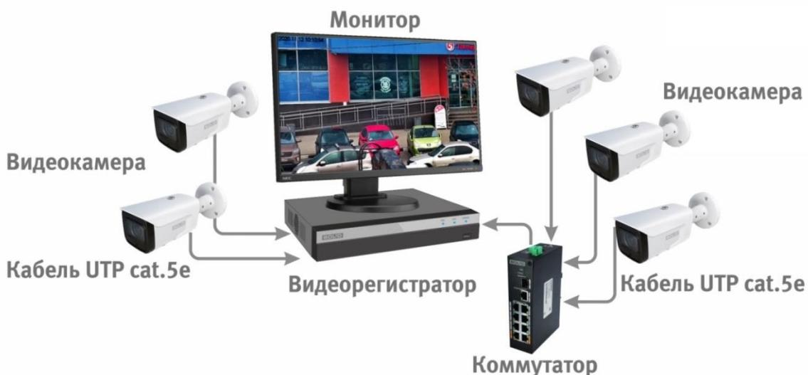
Рисунок 6.4 – Схема подключения видеокамеры к видеорегистратору
