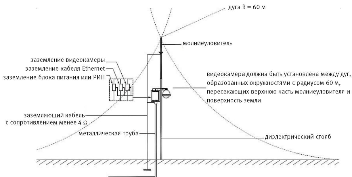
Рисунок 6.5 – Установка молниеотвода
