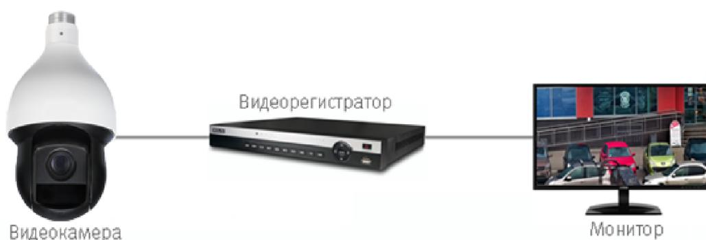
Рисунок 6.2 – Схема подключения видеокамеры
