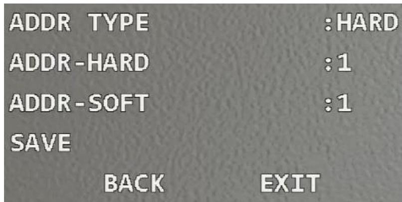
Рисунок 7.6 – Изменение адреса устройства
