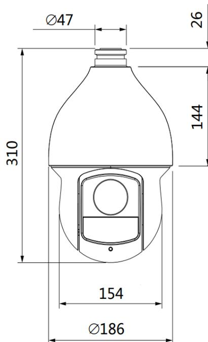
Рисунок 5.1 – Габаритные размеры видеокamеры
