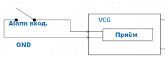
Рисунок 6.4 – Схема под ключения тревожного входа
