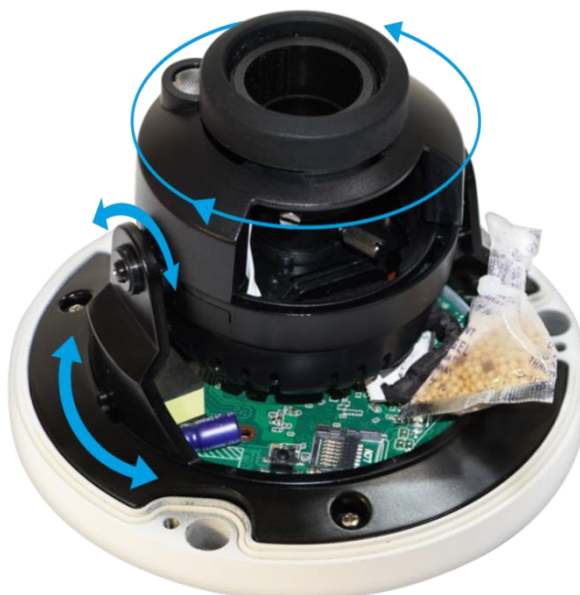
Рисунок 6.5 – Настройка направления объектива
