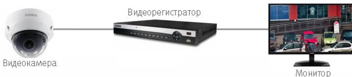
Рисунок 6.2 – Схема подключения видеокамеры
