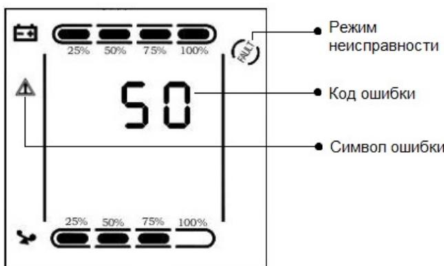
В данном режиме ИБП отключает выход, и на ЖК-дисплее отображаются коды ошибок (Таблица 14). Возможно отключение звука нажатием клавиш  $\leftarrow + \rightarrow$ , чтобы зуммер временно перестал издавать звуковой сигнал в ожидании технического обслуживания.
