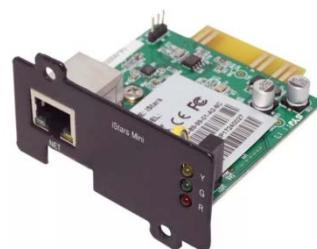
2.3.9.2 Карта сухих контактов AS400 предназначена для преобразования внутренних сигналов ИБП в сигналы интерфейса «Сухие контакты» с гальванической развязкой. Карта обеспечивает передачу от ИБП аварийных сигналов, а также информацию о режиме работы ИБП.
