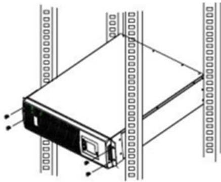
В стойке для установки рекомендуется использовать [рельсы для ИБП](#). Будьте внимательны, не устанавливайте ИБП в перевернутом состоянии. Правильное положение показано на рисунке (ЖК дисплей расположен справа).
