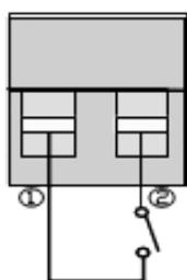
При активации EPO (разрыве цепи между контактами), ИБП мгновенно отключает подключенную нагрузку и все силовые преобразователи, и переключается в режим индикации неисправности.
