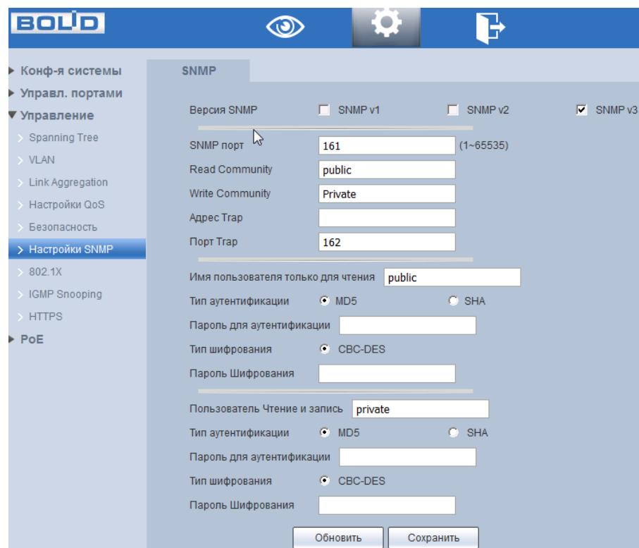
Рисунок 6.31 – Настройки SNMPv3
