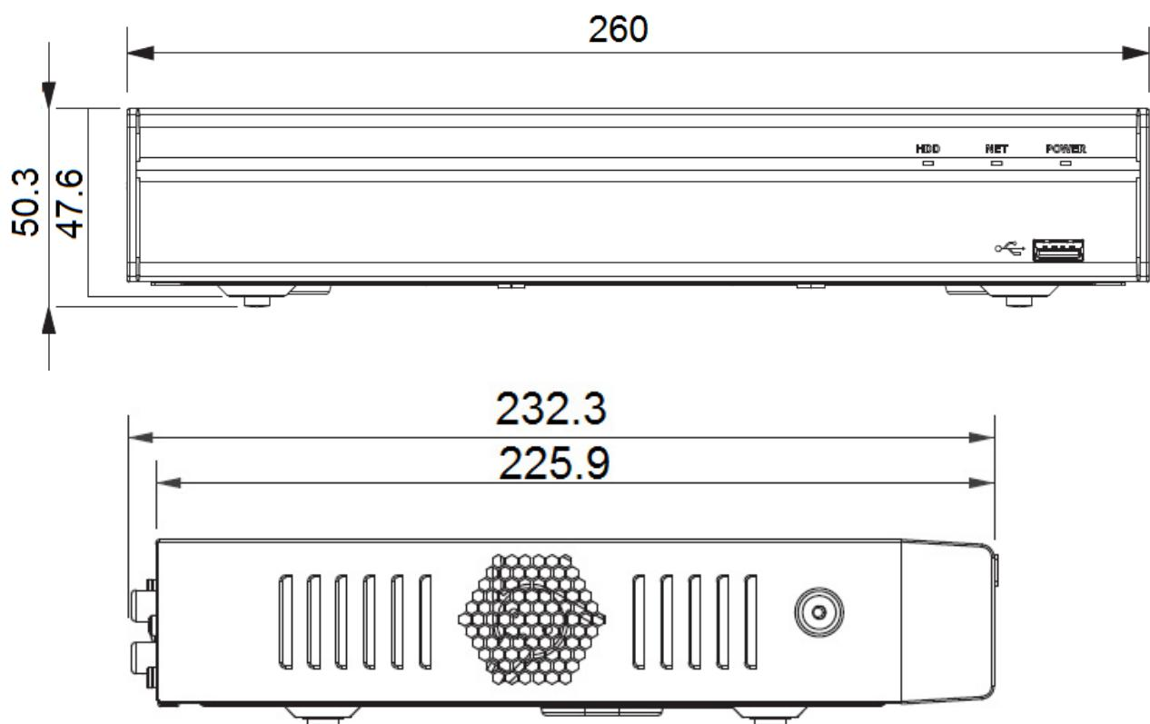
Рисунок 4.1 – Габаритные размеры видеорегистратора
