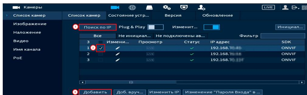
Рисунок 10.4 – Автоматический поиск и добавление устройств
