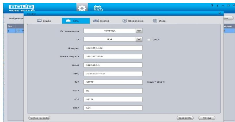
Рисунок 27.2 – Изменение IP-адреса с помощью утилиты «BOLID VideoScan»
