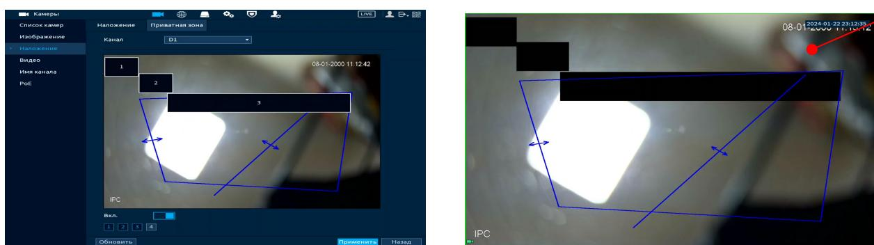
Рисунок 10.32 – Наложение приватных зон на видеопоток
