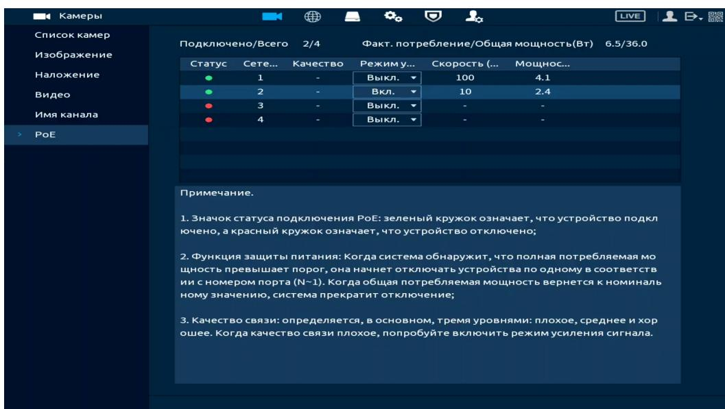
Рисунок 10.24 – Интерфейс просмотра подключенных устройств (PoE)
