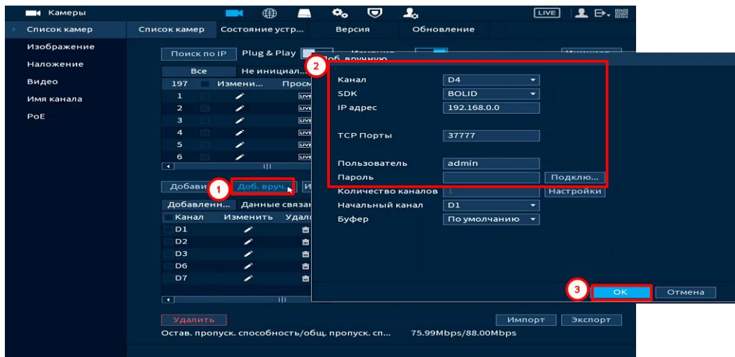
Рисунок 10.14 – Интерфейс ручного добавления удалённого устройства
