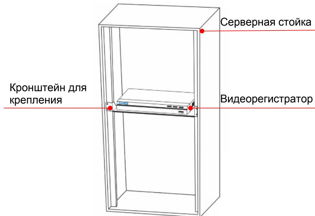
Рисунок 4.9 – Монтаж видеорегистратора в 19"-стойку с помощью кронштейна
