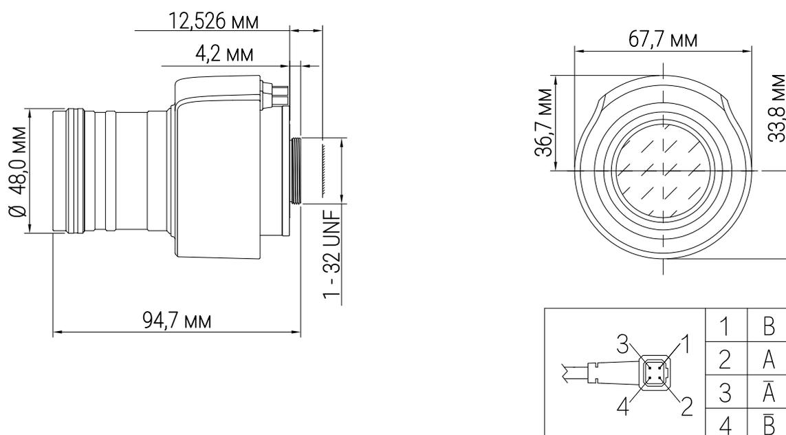
Рисунок 5.1 – Габаритные размеры
