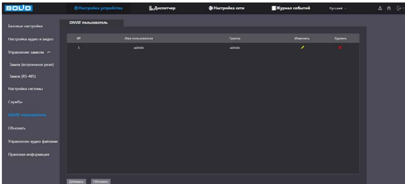
Рисунок 8.9 – Интерфейс просмотра учётной записи ONVIF пользователя
