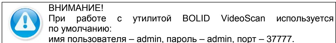
Программа утилиты «BOLID VideoScan» используется для обнаружения текущего IP-адреса устройства в сети, для изменения IP-адреса, управления базовыми настройками, а также для обновления программного обеспечения (Рисунок 14.1).
