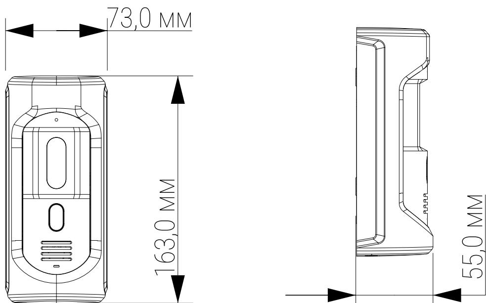
Рисунок 4.1 – Габаритные размеры
