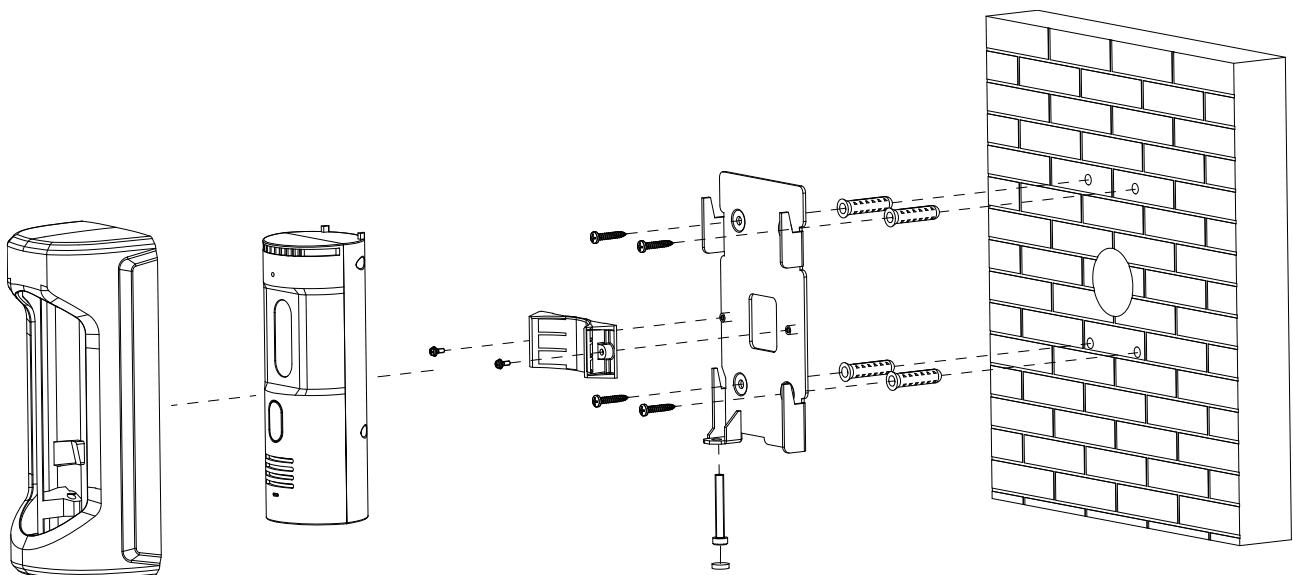
Рисунок 4.3 – Схема крепления
