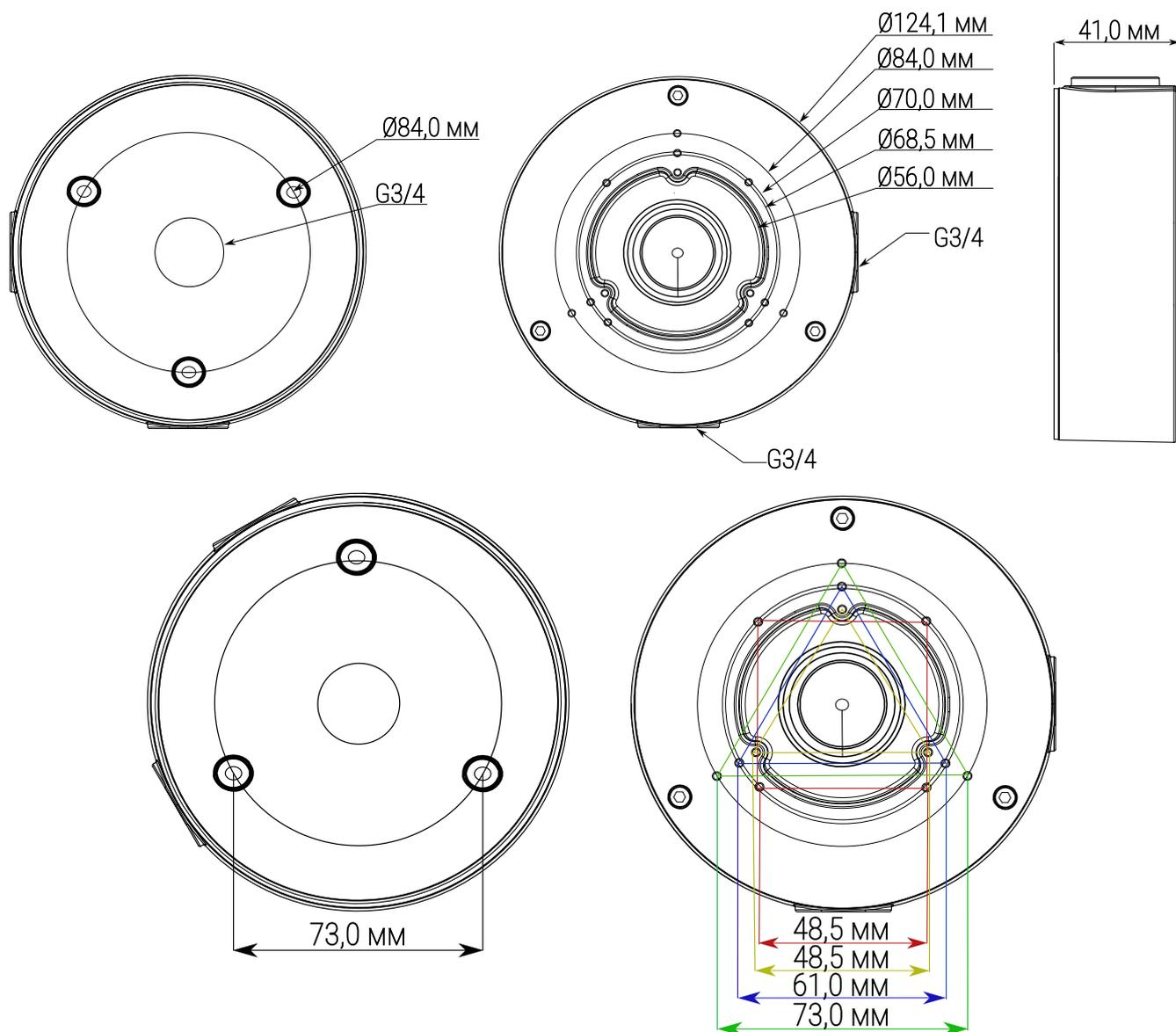
Рисунок 4.1 – Габаритные размеры
