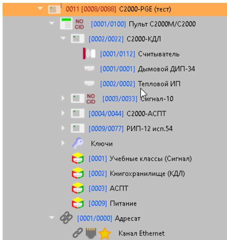
Рис.49 Пример конфигурации в менеджере конфигурации при работе C2000-PGE в режиме «Slave».
