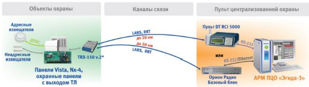
Рис.2 Схема подключения панели с телефонным выходом
