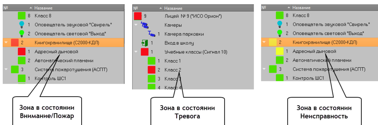
Рис. 34 Пример смены состояния зон и раздела при тревогах, пожарах и неисправностях
