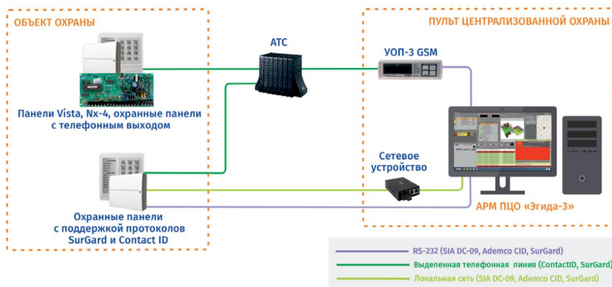
Рис.1 Схема подключение охранных панелей с телефонным коммуникатором через ГТС
