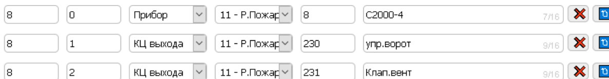
Рис.45 Релейный выход и входы зоны прибора C2000-4 в конфигурации PGE.
