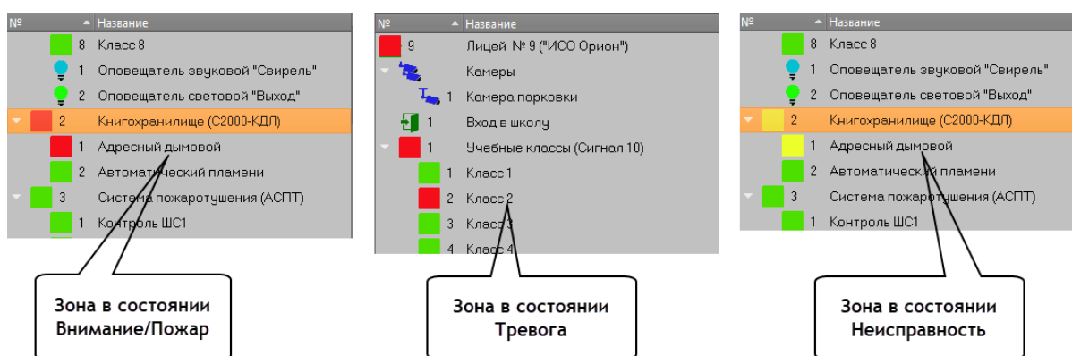
Рис. 53 Пример смены состояния зон и раздела при тревогах, пожарах и неисправностях
