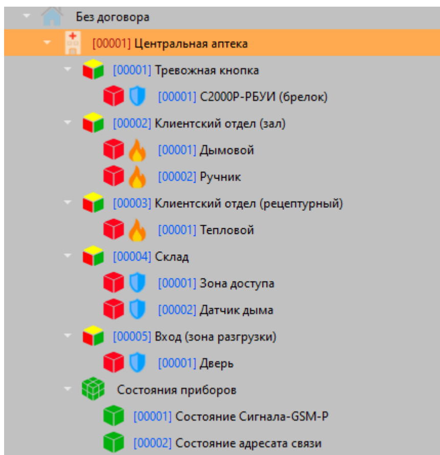
Рис. 39 Пример компоновки объекта охраны в логической иерархии
